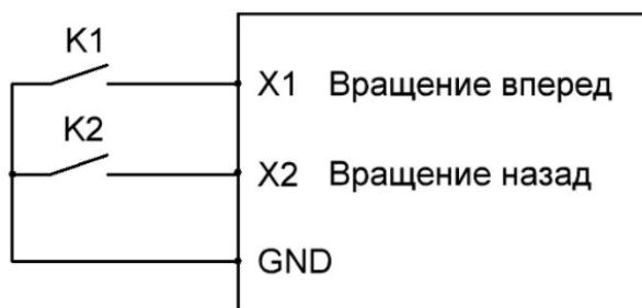
Рис. 5-11 Принципиальная схема двухпроводного режима работы
